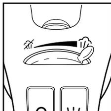
7. Para apagar la plancha, fije la perilla de vapor ajustable en la posición de **planchar en seco**
