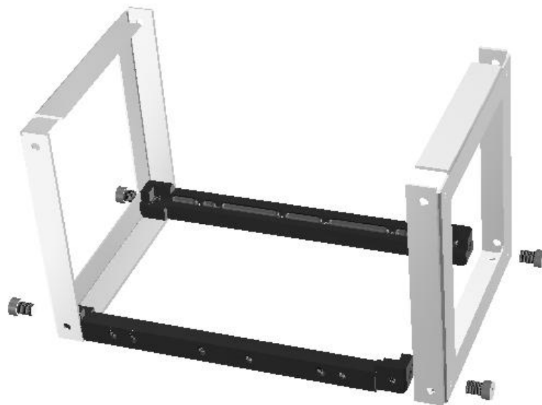
图 3. 将两个滑轨安装在卡架端盖上。
