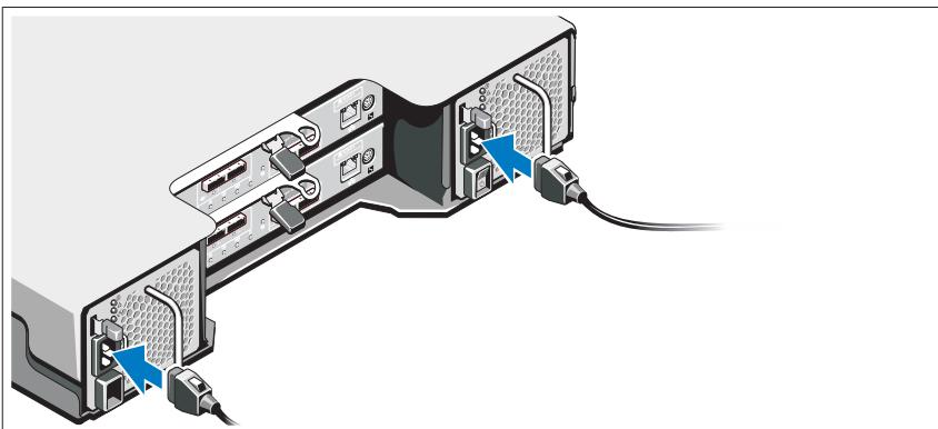
Asegúrese de que el conmutador de alimentación esté en la posición de APAGADO antes de conectar los cables de alimentación. Conecte los cables de alimentación al sistema.
