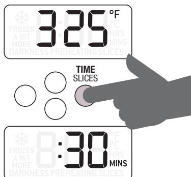
Pressez les flèches vers le bas ou le haut pour ajuster le temps de cuisson par tranches d'une minute, jusqu'à concurrence d'une heure, et par tranches de 5 minutes entre 1 et 2 heures.
