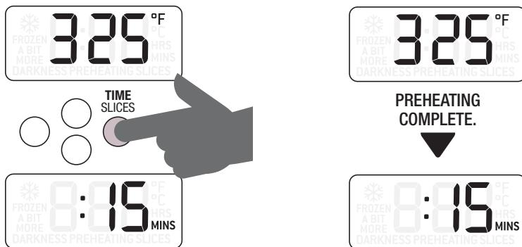
Pressez les flèches vers le haut ou le bas pour ajuster le temps et la température de cuisson par tranches d'une minute, jusqu'à un maximum d'une heure, et par tranches de 5 minutes entre 1 et 2 heures.
