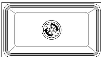
**Note:** Les éléments du bas sont illustrés à des fins de clarté seulement. Ils sont en fait situés sous le plancher de la cavité du four.
