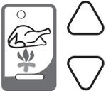
**Zum Festlegen der Back-/Brattemperatur** — Die BRATEN/BACKEN-Taste drücken. Die Vorwärm-Kontrollleuchte leuchtet auf und die zuletzt eingestellte Back-/Brattemperatur wird eingeblendet. Wenn die Back-/Brattemperatur geändert werden soll, die AUF- oder AB-PFEILTasten drücken.
