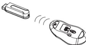
3. Cuando el botón de conexión del receptor se encuentre accionado, se iluminará el LED del interior del mismo. Tan pronto como se haya completado el enlace se apagará el LED.
