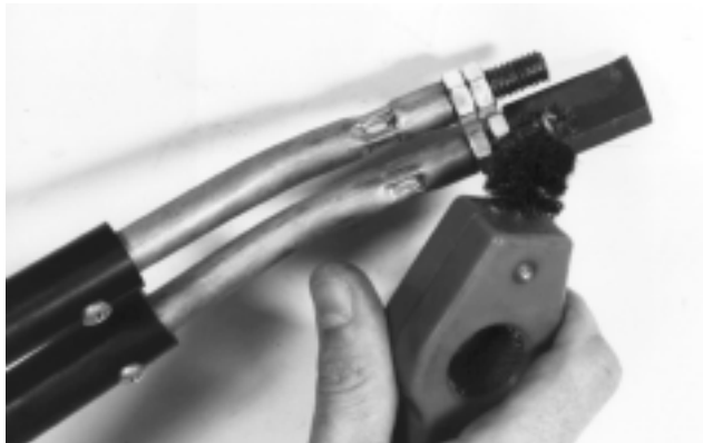
Figure 9 – Nettoyage des goujons filetés
