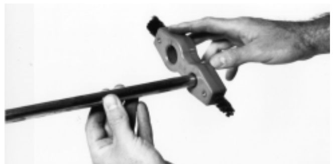
Figura 3 – Limpieza del tubo de cobre y el fitting de conexión
