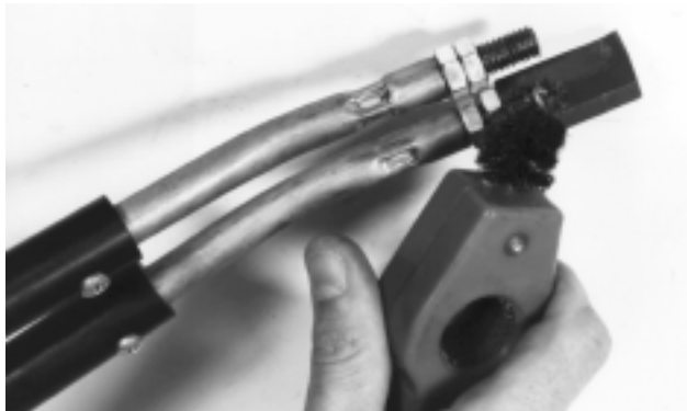
Figura 9 – Limpieza de las espigas roscadas
