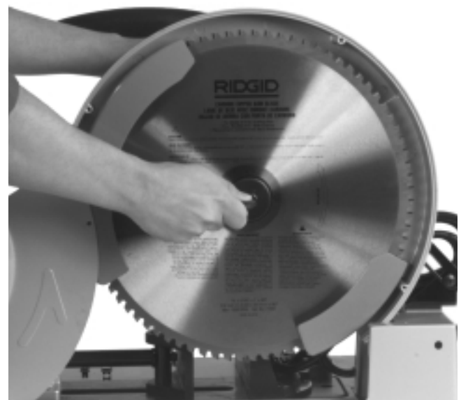
Figure 9 – Installation du disque de tronçonneuse
