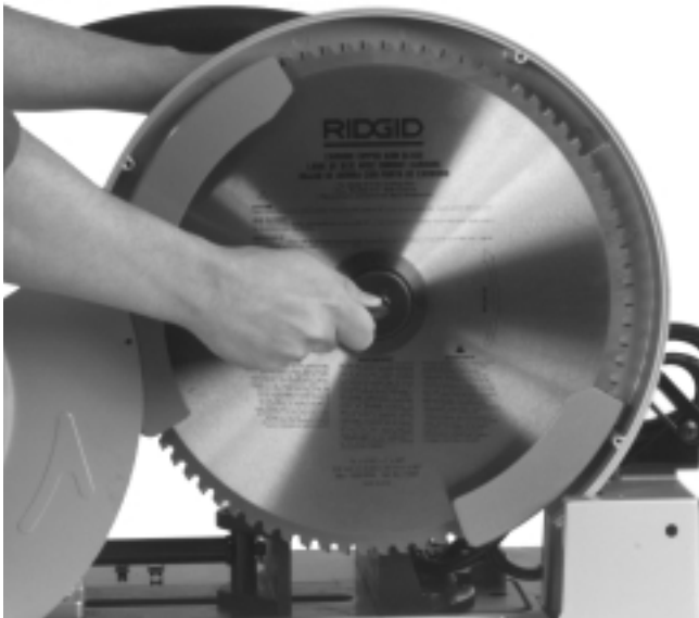
Figura 9 – Instalación de la hoja de corte
