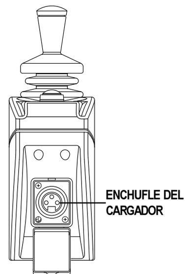
**Figura 26b. Vista del Frente del Controlador Piloto**
