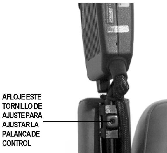
Figura 17. Extensión de la Palanca de Control
