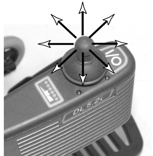
**Figura 26. Función de la Palanca de control**
