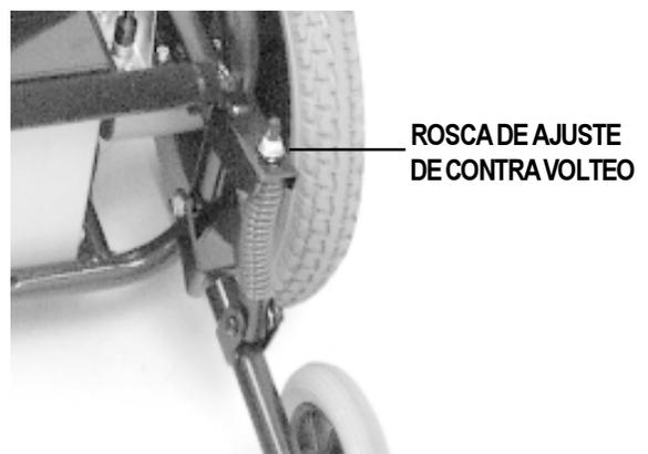
**Figura 23. Ajuste de Contra Volteo**
