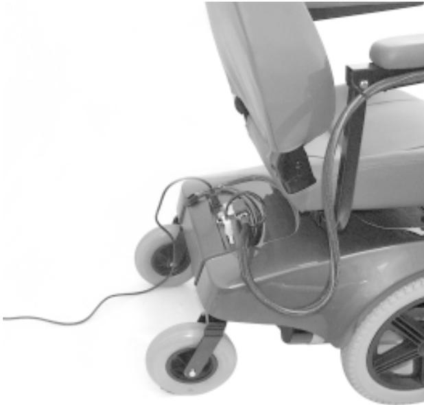
**Figura 11. Conector del Cargador Inhibido**
