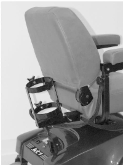
**Figura 33. Soporte para el Tanque de Oxígeno**
