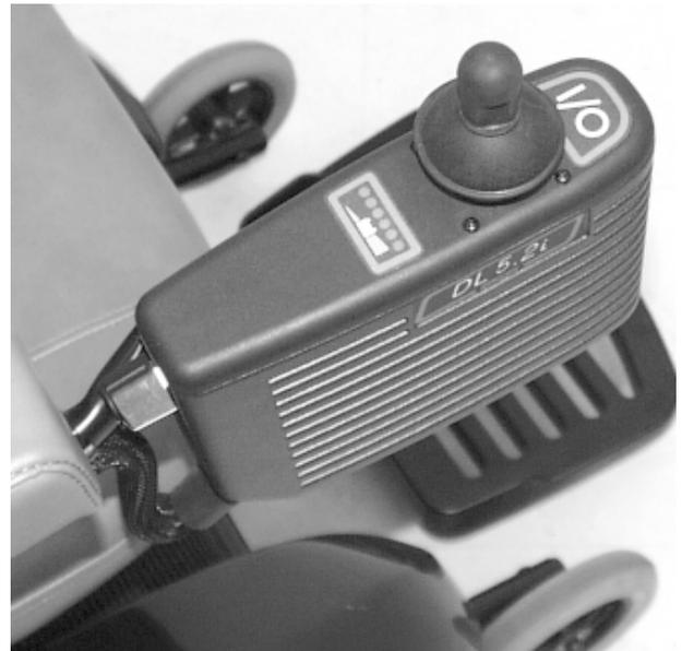
**Figura 12. Controlador de la Palanca Dinámico**
