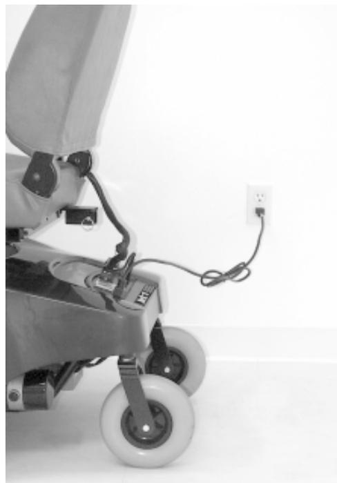
**Figura 3. Cordón del Cargador de la Batería**
