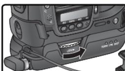
**6** Soulevez la protection du port USB de l'appareil photo et connectez le câble USB au port USB.
