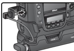
7 Pase el cable por la guía de la tapa del compartimento de la batería BL-2.
