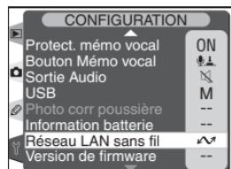
4 Sélectionnez **Activé** pour l'option **Emetteur** de la rubrique **Réseau LAN sans fil** du menu Configuration de l'appareil ( 12).
