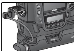
**7** Passez le câble derrière la glissière située sur le volet du logement pour accumulateur BL-2.
