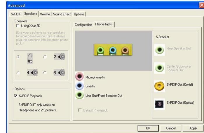
1. Dieser Dialog stellt Ihnen eine Oberfläche zur Verfügung, mit der Sie Ihren Lautsprecher-Modus einstellen können. CMI8738MX 6-Kanal unterstützt den Kopfhörer- 2-Kanal-, 4-Kanal- und 5.1-Kanal-Modus.
