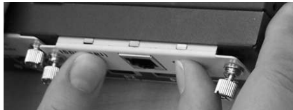
Figure 17: Installing a Mini PIM
