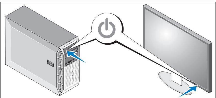
Stiskněte vypínač na počítači a na monитору (volitelný). Kontrolky napájení by se měly rozsvítit. Upravte ovládací prvky monitoru tak, aby byl obraz uspokojivý.
