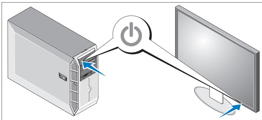
Presione el botón de encendido del sistema y del monitor (opcional). Los indicadores luminosos de alimentación deberían encenderse. Ajuste los controles del monitor hasta que la imagen mostrada sea satisfactoria.
