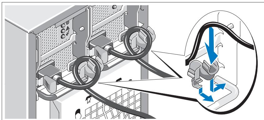
Fije el soporte de retención del cable de alimentación en el codo derecho del asa de la fuente de alimentación. Doble el cable de alimentación del sistema en forma de bucle, tal como se muestra en la ilustración, y fíjelo a la abrazadera correspondiente del soporte. Repita el procedimiento para la segunda fuente de alimentación.
