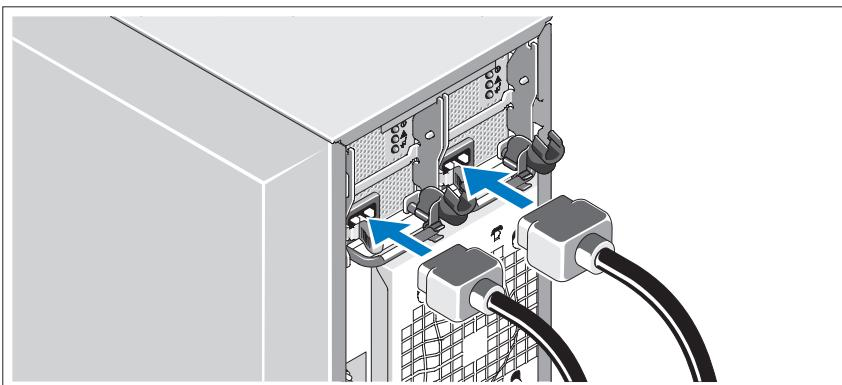
Conecte el cable de alimentación del monitor (opcional) y conecte el cable (o cables) de alimentación del sistema al sistema.
