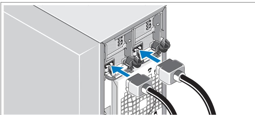
Podłącz kabel zasilania monitora do monitora (opcjonalnie), a następnie kabel (kable) zasilania systemu do komputera.
