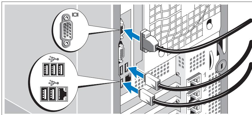
Подключите клавиатуру, мышь и монитор (дополнительно).
