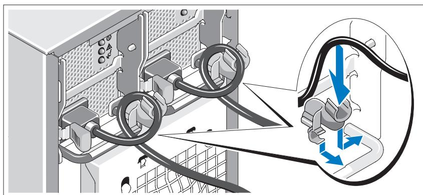
Συνδέστε το στήριγμα συγκράτησης του καλωδίου τροφοδοσίας στο δεξί σύνδεσμο της λαβής της παροχής τροφοδοσίας. Κάμψτε το καλώδιο τροφοδοσίας του συστήματος σε μορφή βρόχου όπως φαίνεται στο σχήμα και συνδέστε το στην αγκράφα του καλωδίου του στηρίγματος. Επαναλάβετε τη διαδικασία για τη δεύτερη παροχή τροφοδοσίας.
