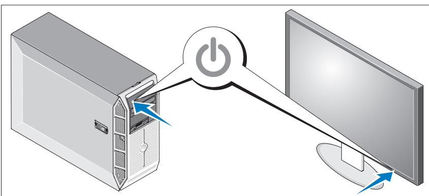
Appuyez sur le bouton d'alimentation du système, puis sur celui du moniteur (si nécessaire). Les voyants d'alimentation doivent s'allumer. Réglez le moniteur jusqu'à ce que l'image soit correctement affichée.
