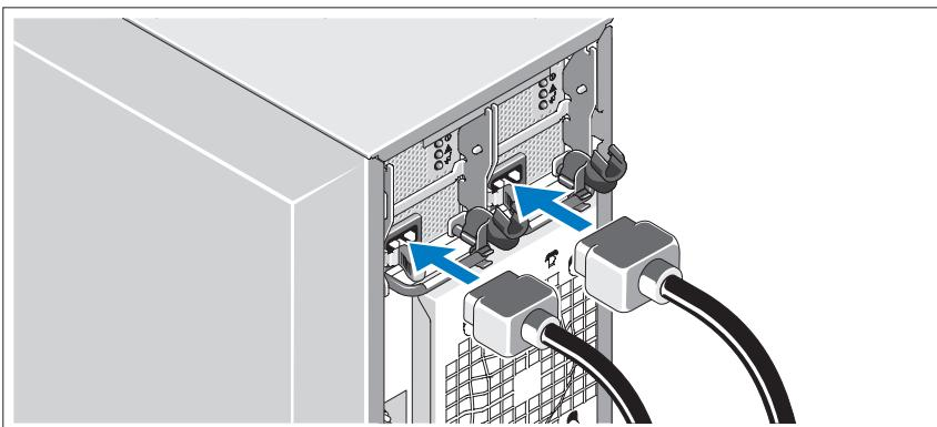
Schließen Sie die entsprechenden Netzstromkabel am Bildschirm (optional) und am System an.
