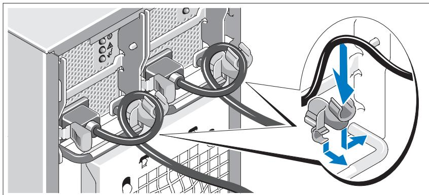
Podłącz wspornik podtrzymujący kabel zasilania do prawego węzła na uchwycie zasilacza. Zegnij kabel zasilacza, tworząc pętlę, w sposób przedstawiony na rysunku i przymocuj do zacisku kabla na wsporniku. Powtórz te czynności dla drugiego zasilacza.
