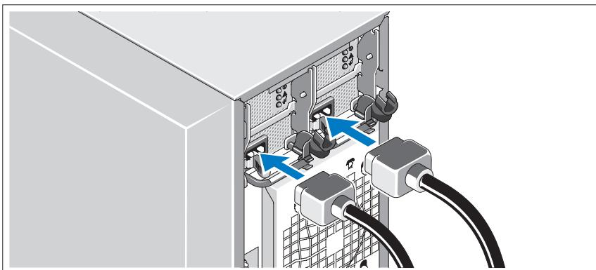
Branchez les câbles d'alimentation appropriés (un sur le moniteur [si nécessaire] et un sur le système).
