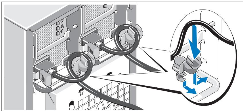
Bringen Sie die Rückhalteklemme für das Netzstromkabel am rechten Bogen des Netzteileigriffs an. Biegen Sie das Netzstromkabel wie abgebildet zu einer Schlaufe und befestigen Sie es an der Kabelklemme. Wiederholen Sie den Vorgang für das zweite Netzteil.
