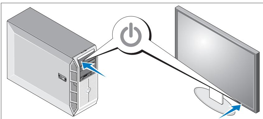
Naciśnij przyciski zasilania systemu i monitora (opcjonalnego). Powinny zaświecić się wskaźniki zasilania. Wyreguluj ustawienia monitora aż do uzyskania odpowiedniego obrazu.
