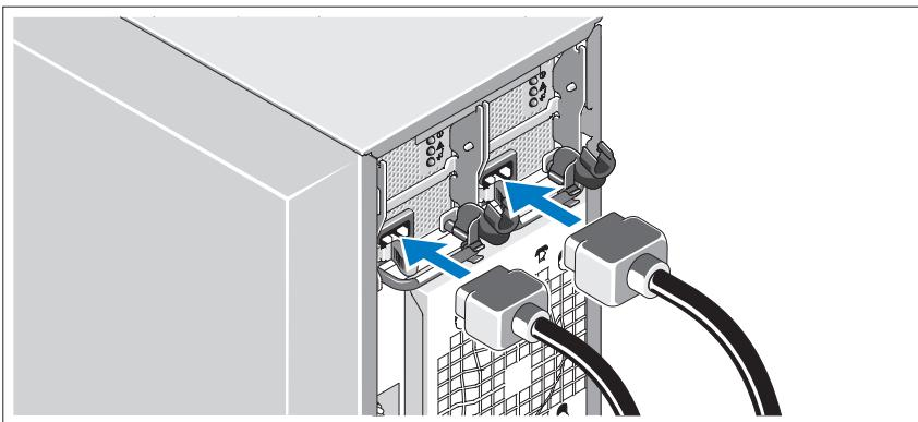
Napájecí kabel monitoru připojte k monitoru (volitelný) a napájecí kably počítače připojte k počítači.
