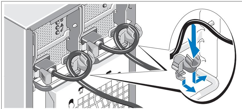
Fixez le support du câble sur la partie droite de la poignée du bloc d'alimentation. Faites une boucle comme indiqué dans l'illustration et insérez le câble d'alimentation dans le clip du support. Recommez cette procédure pour le second bloc d'alimentation.
