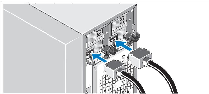
Συνδέστε στην οιδόνη το καλώδιο τροφοδοσίας οιδόνης (προαιρετικά) και συνδέστε στο σύστημα το(τα) καλώδιο(-α) τροφοδοσίας του συστήματος.
