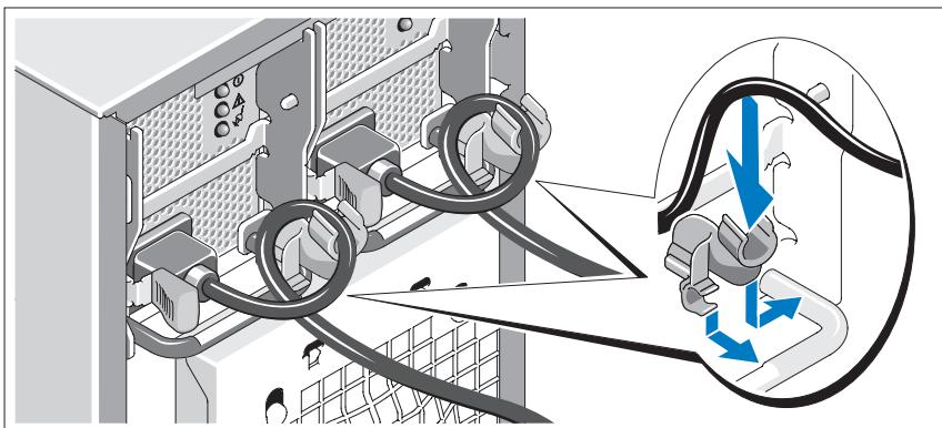
Připevněte držák napájecího kabelu do pravého ohybu rukojeti napájecího zdroje. Udělejte na napájecím kabelu smyčku, jak je znázorněno na obrázku, a připevněte ho do příslušného úchytu. Celý postup zopakujte u druhého napájecího kabelu.
