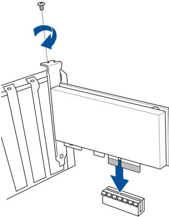
So installieren Sie eine PCIE x1 Karte
