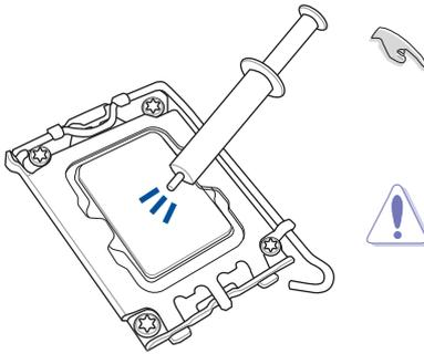
Falls erforderlich, tragen Sie die Wärmeleitpaste auf dem CPU-Kühlsystem und der CPU auf, bevor Sie das Kühlsystem installieren.
