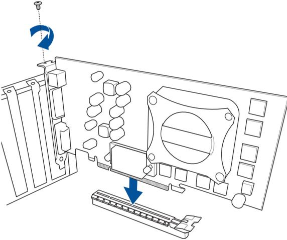
So installieren Sie eine PCIE x4 Karte
