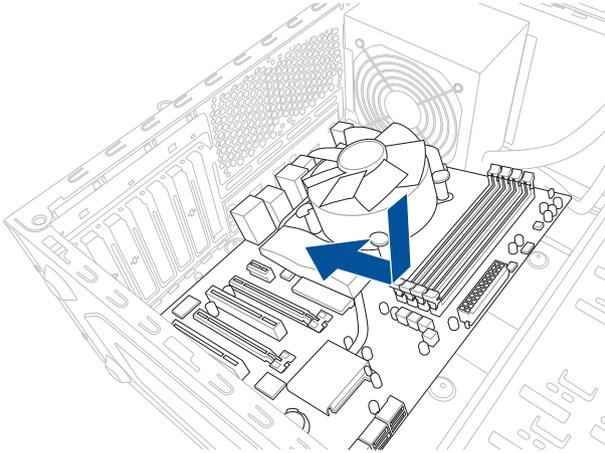
2. Setzen Sie neun (9) Schrauben in die durch Kreise markierten Bohrlöcher ein, um das Motherboard im Gehäuse zu befestigen.
